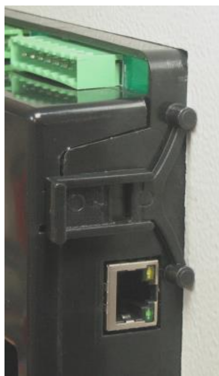
Instalação do suporte do tipo autorretenção
